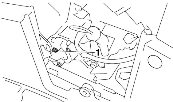
1. Болт воздухоотводного отверстия водяного насоса
